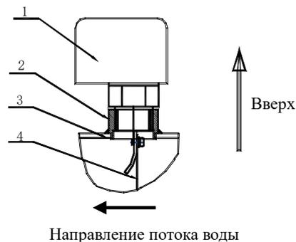
На рисунке ниже показан способ установки реле потока воды и пластин направления потока.
