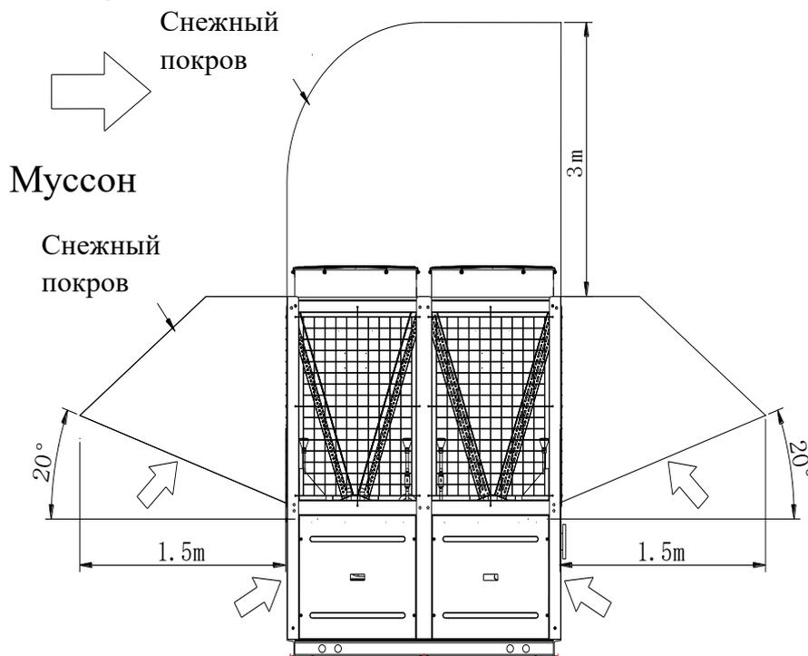
Схема установки в зоне замерзания:
