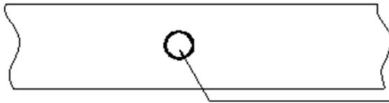
Глухая труба. Нанесите термочувствительный клей на внутреннюю сторону и вставьте датчик температуры воды на входе/выходе
