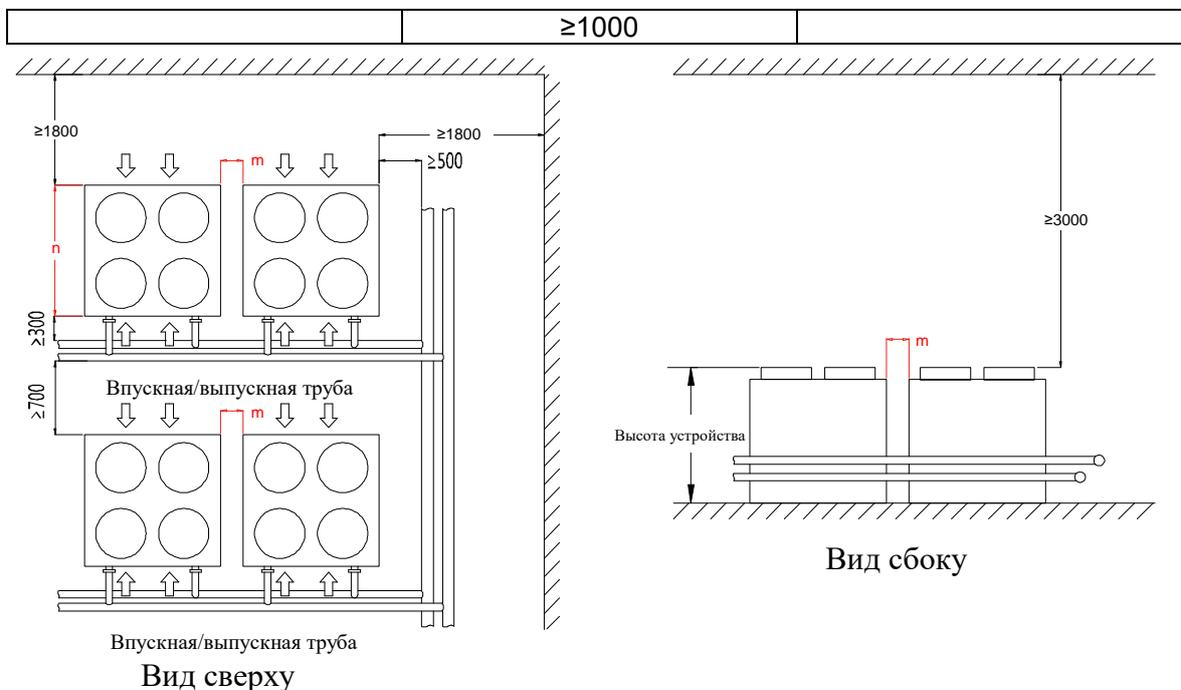
На рисунке ниже показано монтажное пространство для устройств TAS330AH, TAS440AH.
