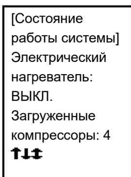
На экране **[Состояние работы устройства]** выберите **Состояние работы системы** и нажмите **<ОК>**, чтобы открыть экран **[Состояние работы системы]**, который содержит два пункта меню и может переключаться нажатием кнопок **<▲ или ▼>**.
